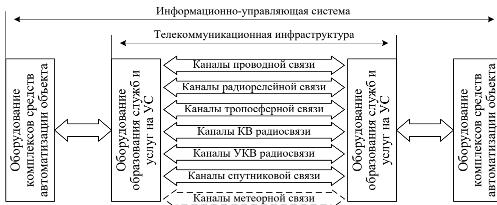
Рис. 2. Обобщённая схема, отражающая место метеорной связи в телекоммуникационной инфраструктуре информационно-управляющих систем
